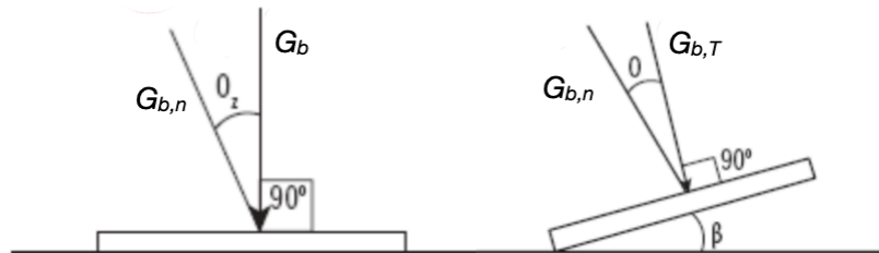
Ilustración 5: Parámetros trigonométricos que definen el factor de inclinación. Fuente: elaboración propia.
