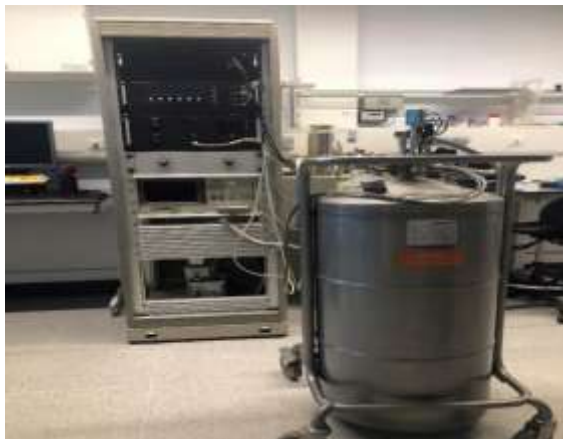
Figura 8: Equipo de espectroscopia dieléctrica utilizado en el laboratorio.
