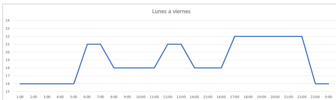
Figura 6.3 - Perfil del termostato de una vivienda. Fuente: (204)
