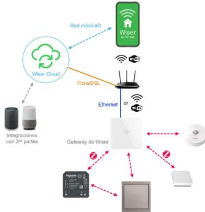
Figura 4.10 - Esquema de funcionamiento del ecosistema doméstico Wiser de Schneider Electric. Fuente interna.
