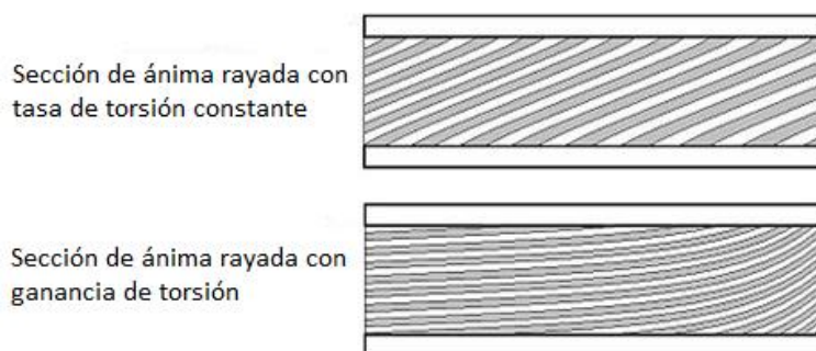
Ilustración 8: Diferencias entre estriado convencional y progresivo
