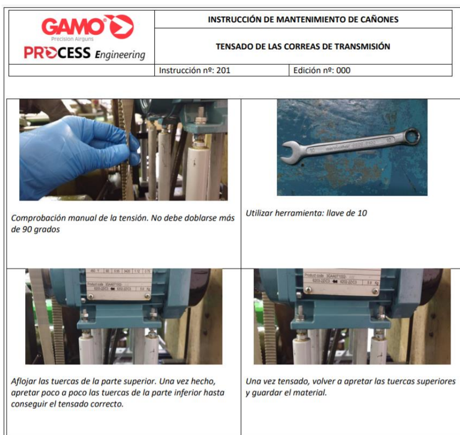
Ilustración 49: Ejemplo de instrucción de mantenimiento. Tensado de las correas
