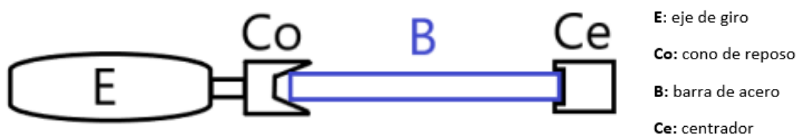
Ilustración 35: Esquema del sistema de sujeción de la pieza
