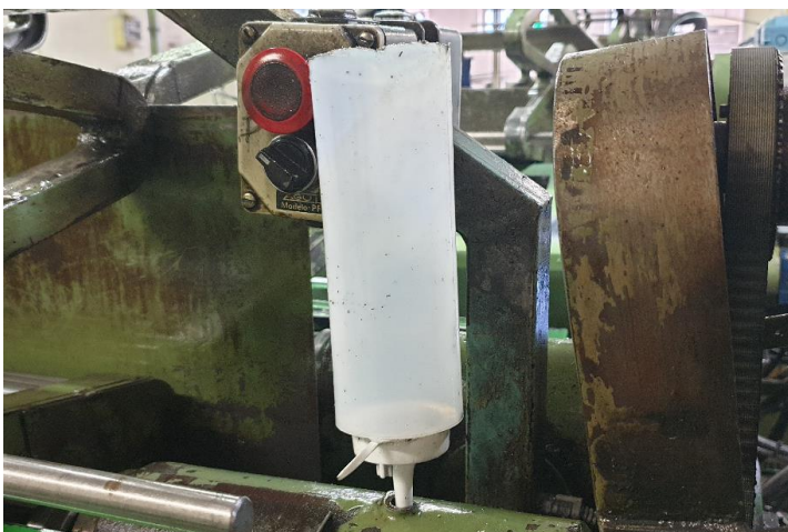
Ilustración 44: Sistema provisional de lubricación/refrigeración del eje de giro
