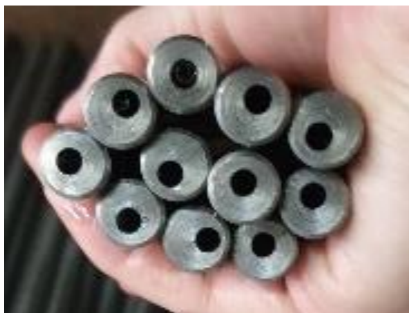
Ilustración 23: Ejemplo gráfico de la irregularidad del centramiento del taladro
