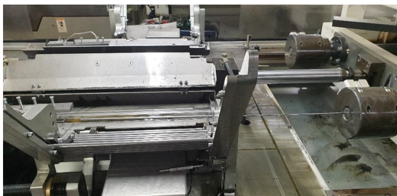
Ilustración 18: Centro de rayado del ánima
