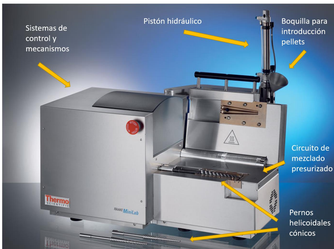
Ilustración 4 Haake MiniLab equipo de extrusión mecánico
