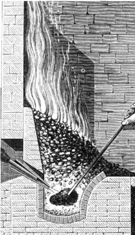
Figura 2. Horno en una fragua catalana. Foto: www.xtec.cat
