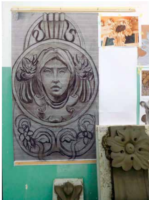
16 Izrada ukrasa u radionici, crtež u mjerilu 1:1 (foto: S. Buble, 2018.)
