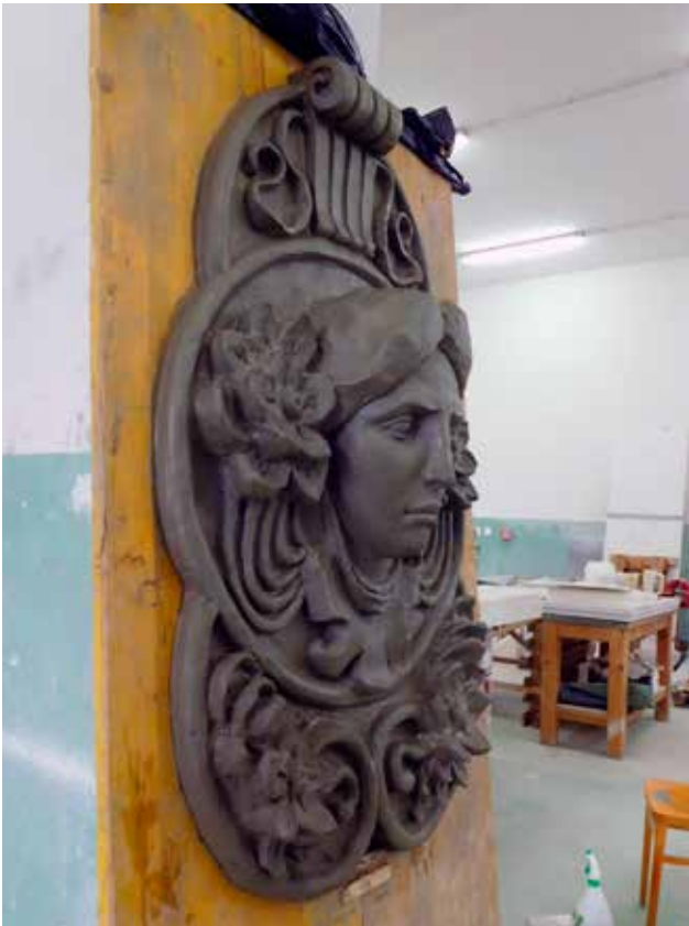
17 Izrada ukrasa u radionici, glineni model u mjerilu 1:1 (foto: S. Buble, 2018.)
