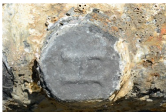
Fig.3.- Marca de fundición "H" (Husbey) sobre un muñón
