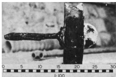
Fig. 1 – Pieza circular de aleación de cobre y eje de hierro, catalogada como rueda de cureña (Irion 1980: fig. 4); posteriormente identificada como la roldana de un elemento de aparejo (e.g. cuadernal o serviola).
