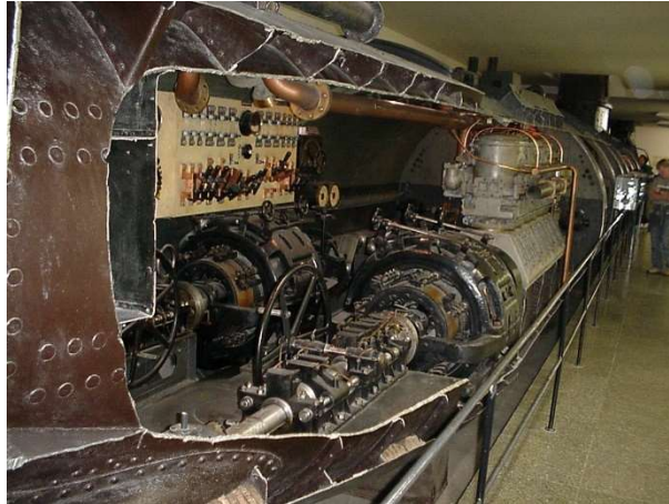
Figura 25. O submarino original U.1 com motor Körting a querosene.
