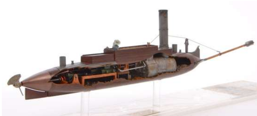
Figura 20. Maquete do CSS David com um torpedo Spar na proa 35 .
