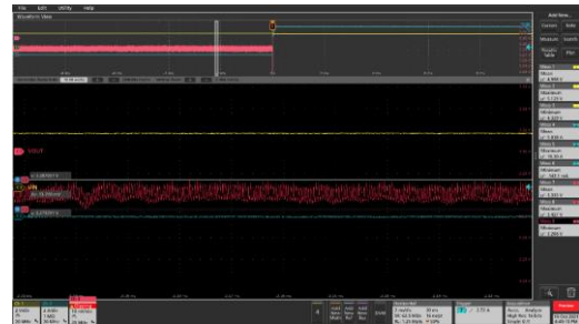
(d) EPC2218 unloaded ripple voltage
