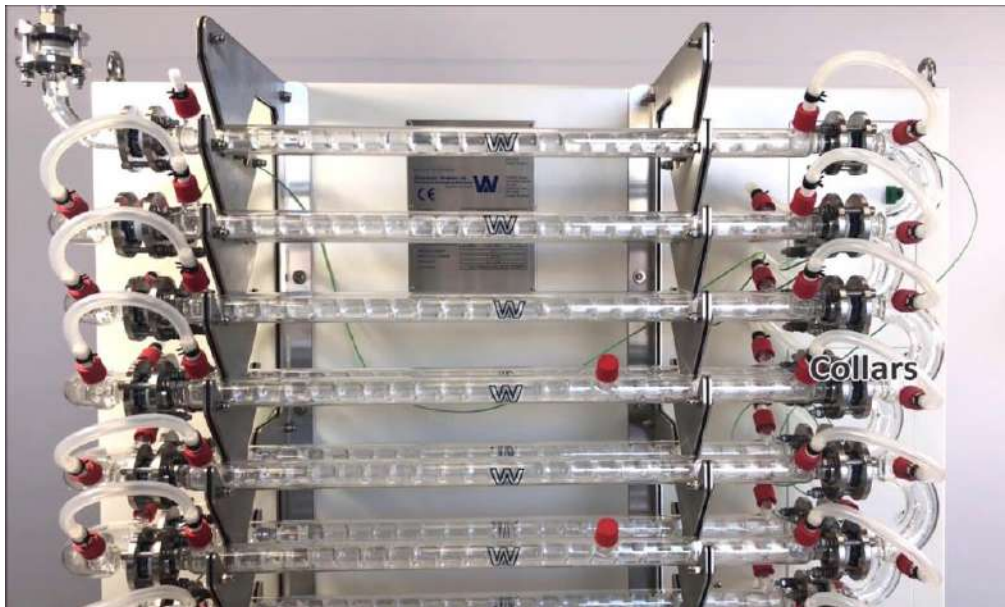
Figure I.25: Le réacteur oscillatoire continu développé par NiTech Solutions Ltd (Nitech Solutions, 2019)
