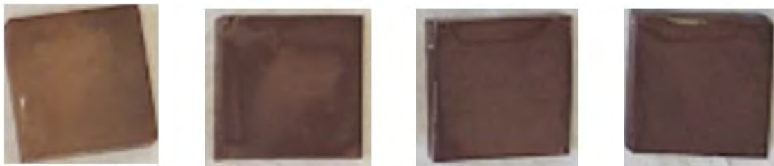
Figure 10 Photographies des films minces de pérovskites 3D et mix 3D + 5, 10 et 15 % mol. 2D (de gauche à droite) sur substrats de FTO.
