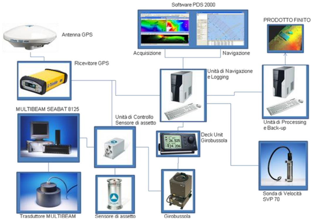
Figura 2: Schema operativo di un tipico sistema multibeam
