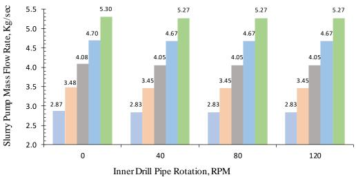
■ Pump RPM = 500 ■ Pump RPM = 600 ■ Pump RPM = 700 ■ Pump RPM = 800 ■ Pump RPM = 900
