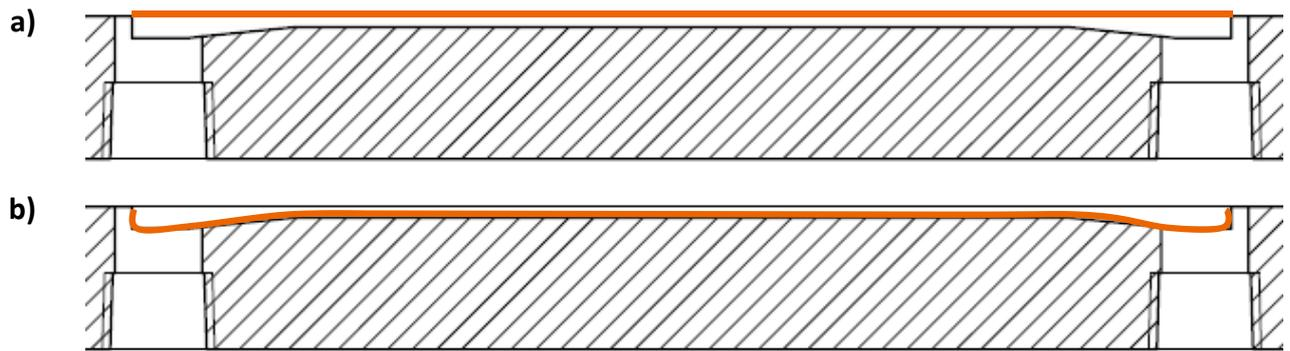
Abbildung 25: Querschnitt der unteren Zellenhälfte mit eingesetzter Polymermembran. a) bis b) zeigen die Deformation der Polymermembran (orange) über die Dauer des angelegten Überdrucks. a) Start der Messung, Polymermembran ist nicht deformiert. b) Polymermembran wird auf die gegenüberliegende Messzellenwand gedrückt.
