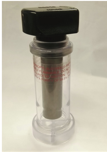
Abbildung 5.5: Entnehmbarer Wick im Aufbewahrungsbehälter zum Tränken mit Isopropanol für das PN-PEMS der Firma AIP.
