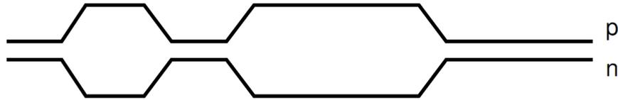
Abbildung 2.1.: Signalverlauf mit differentiellen Leiterpaar [1, S. 5]
