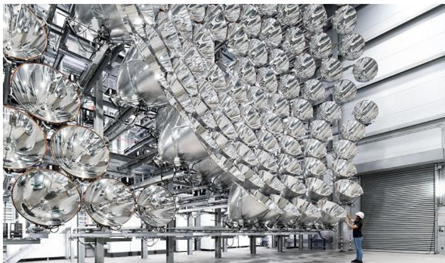
Abb. 1.1 Strahler mit Xenon-Kurzbogenlampen im Hochleistungsstrahler SYNLIGHT in Jülich [2]
