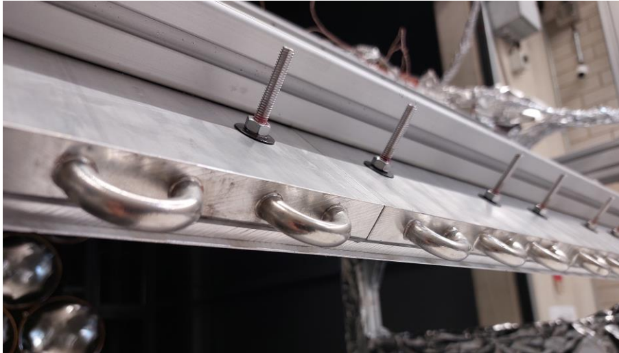
Abb. 5.19 Optische Kontrolle der therm. Schnittstellen nach der Bestrahlung an der Unterseite des Reflektors
