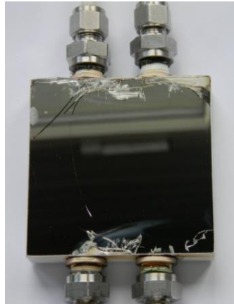
Abb. 2.11 Durch Temperaturgradienten während des Bestrahlungstests gesprungener Thin-Glass Mirror aus den Untersuchungen von Fernández-García et al. [11]
