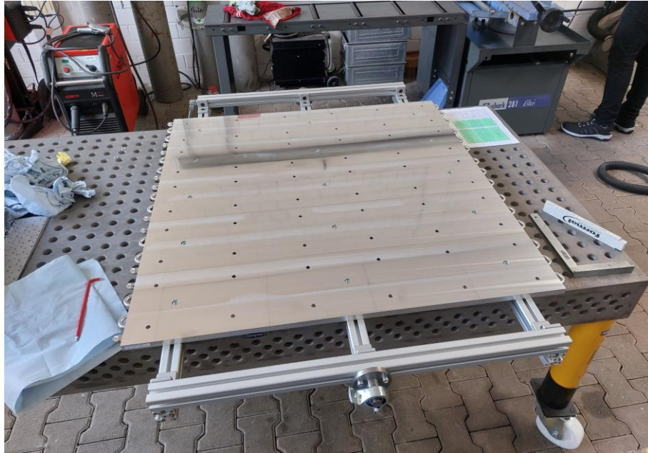
Abb. 5.5 Kühlkörpersegmente während Montage auf dem Rahmen
