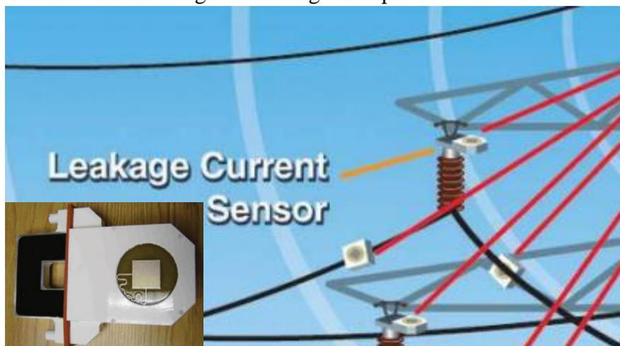
Figura 3. 11 Sensor de corriente de fuga de RF.
