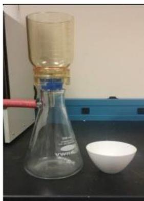
*Figura 2 3 Aparato utilizado para la determinación de sólidos totales en el agua residual*
