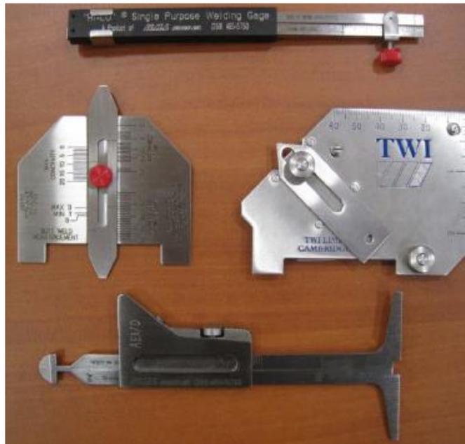
Fig. 3.12. Diferentes galgas empleadas en inspección visual.
