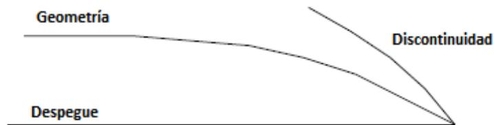
Fig. 2.25. Efecto de la discontinuidad en la curva normalizada. Nota: la señal de despegue es horizontal, tal como en una inspección típica.
