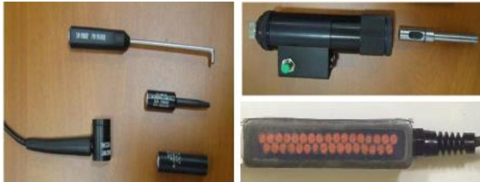
Fig. 10.19. Diferentes tipos de sondas: tipo lápiz, sondas rotatorias para inspección de taladros y sondas array.
