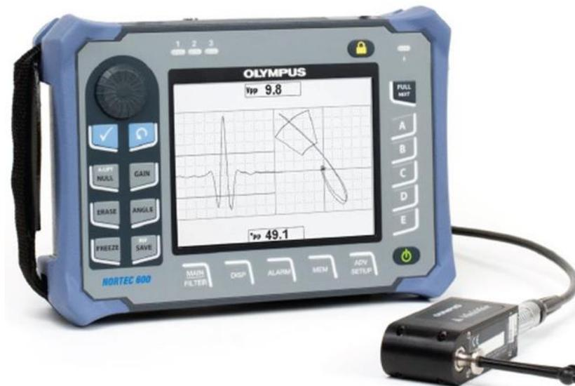
Fig. A.1. Panel frontal del NORTEC 600.
