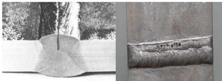
Fig. 1.4. Grietas y poros (Soldadura).
