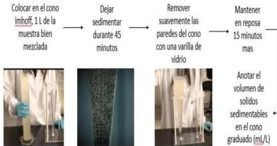
Figura N° 24. Esquema del procedimiento experimental para Sólidos Sedimentables.
