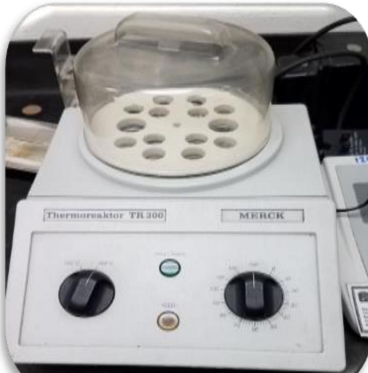
Figura N° 13. Termoreactor TR 300. (Utilizado para la digestión de muestras)
