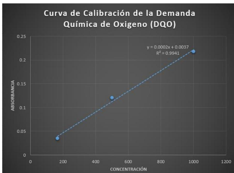
Figura N° 2 Curva de Calibración de DQO y ecuación de la recta
