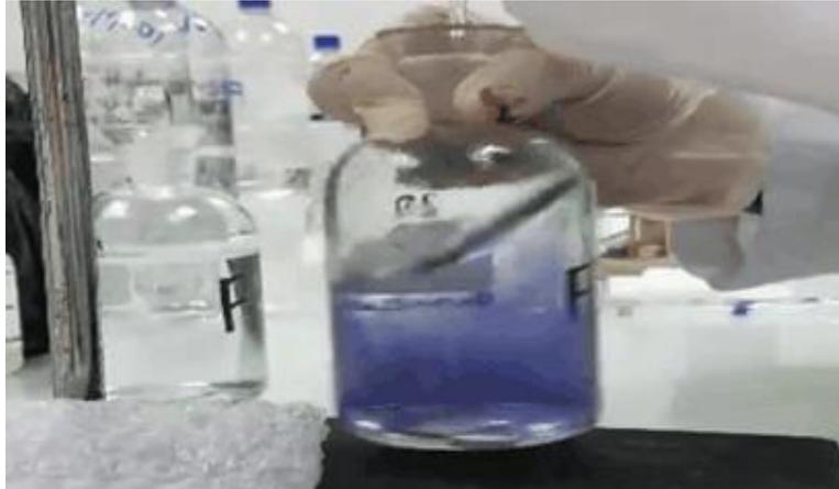
Figura N° 12. Valoración con Tiosulfato de Sodio 0.025 N
