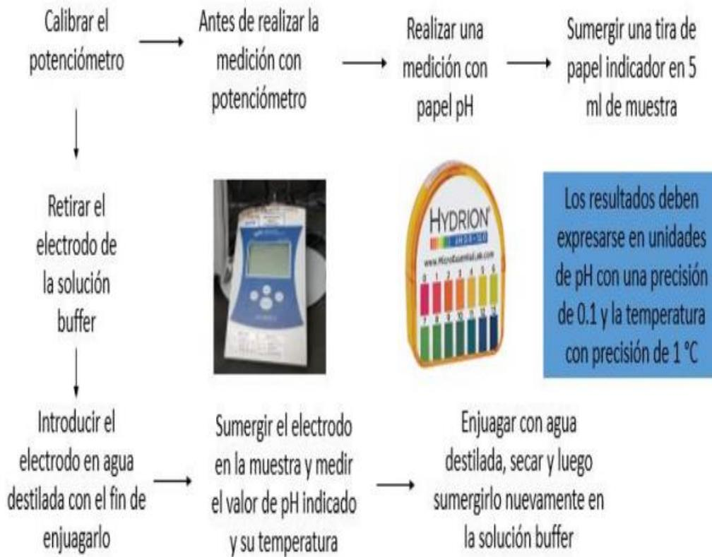
Figura N° 28. Esquema del procedimiento para determinación de pH
