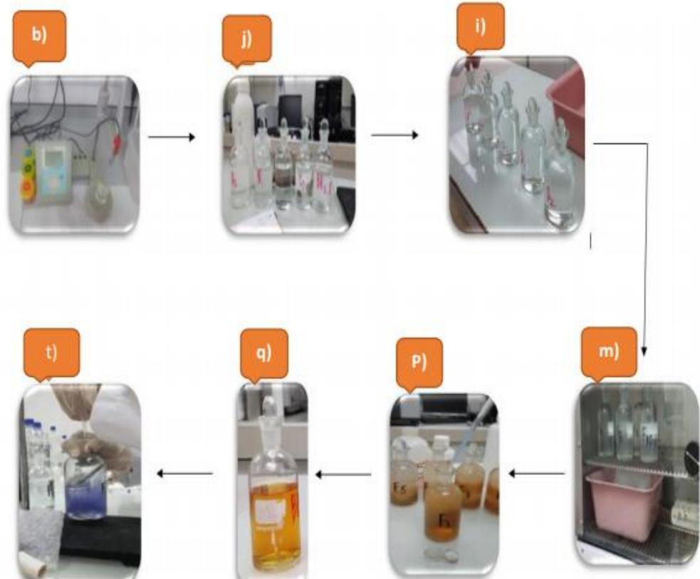
Figura N°. 22 Esquema del procedimiento experimental para la demanda Bioquímica de Oxígeno.
