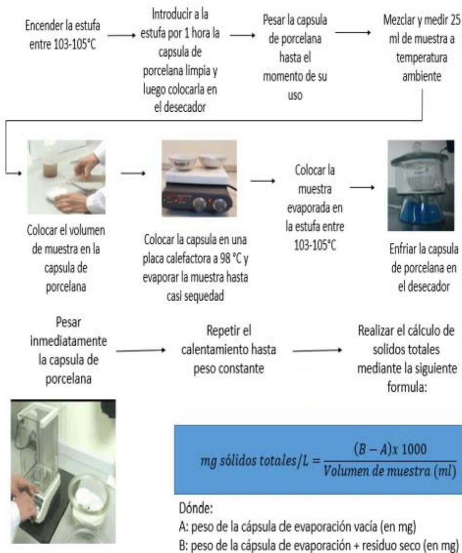
Figura N° 25. Esquema del procedimiento experimental para Sólidos totales.
