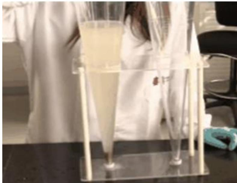
Figura N° 15. Cono Imhoff, utilizado para la determinación de Sólidos Sedimentables
