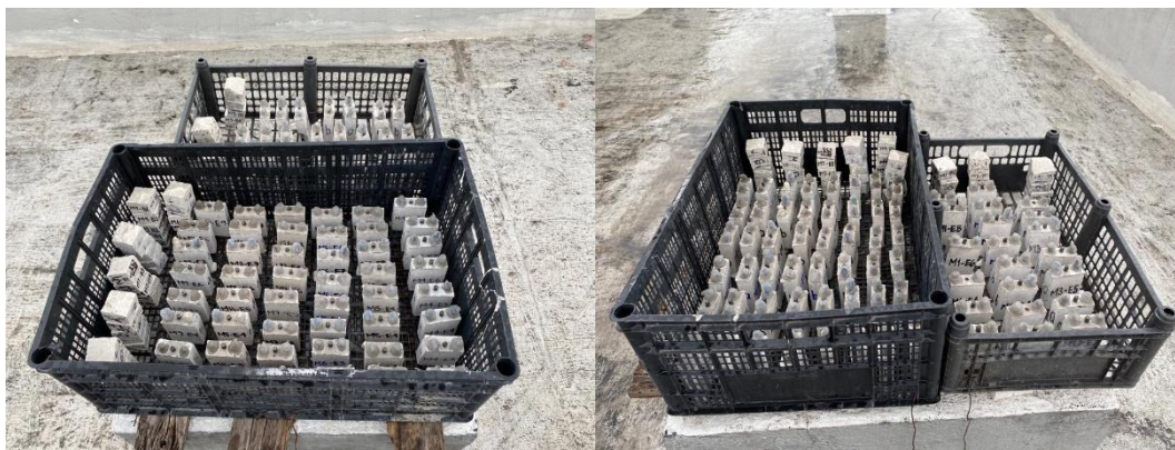
Figura 25. Especímenes de mortero reforzado expuestos a CO 2 en ambiente natural.
