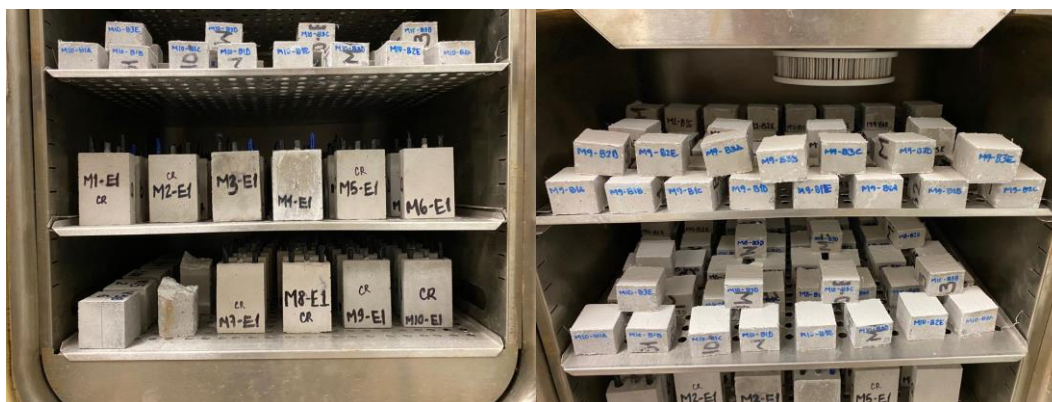
Figura 26. Especímenes de mortero reforzado expuestos a 4% \text{CO}_2 en cámara de carbonatación con humedad relativa 70 \pm 10\% .
