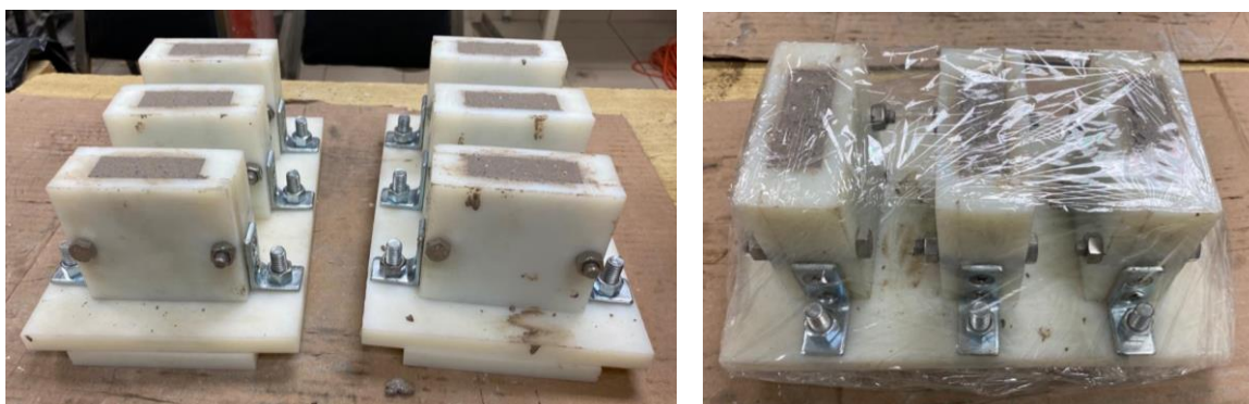
Figura 23. (a) Llenado, (b) protección de moldes de especímenes prismáticos de mortero.
