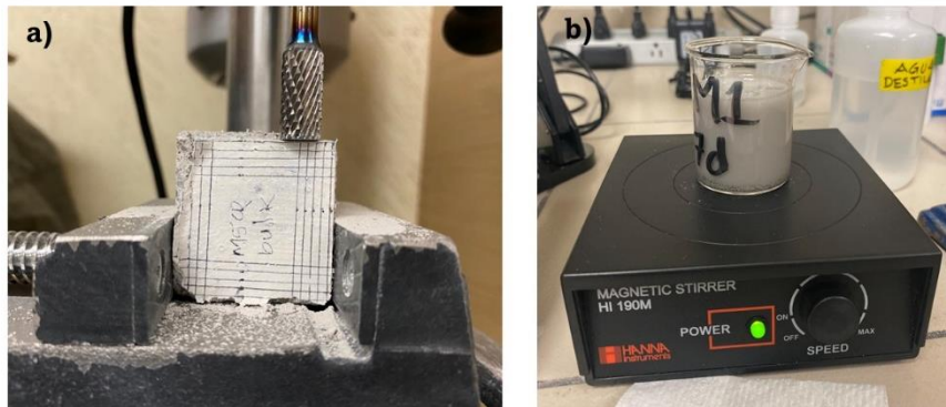
Figura 29. a) Desbaste de especimen de mortero, b) agitación de polvos para obtención de pH.
