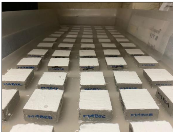
Figura 27. Especímenes de mortero en inmersión en agua con NaCl a 3.5%.
