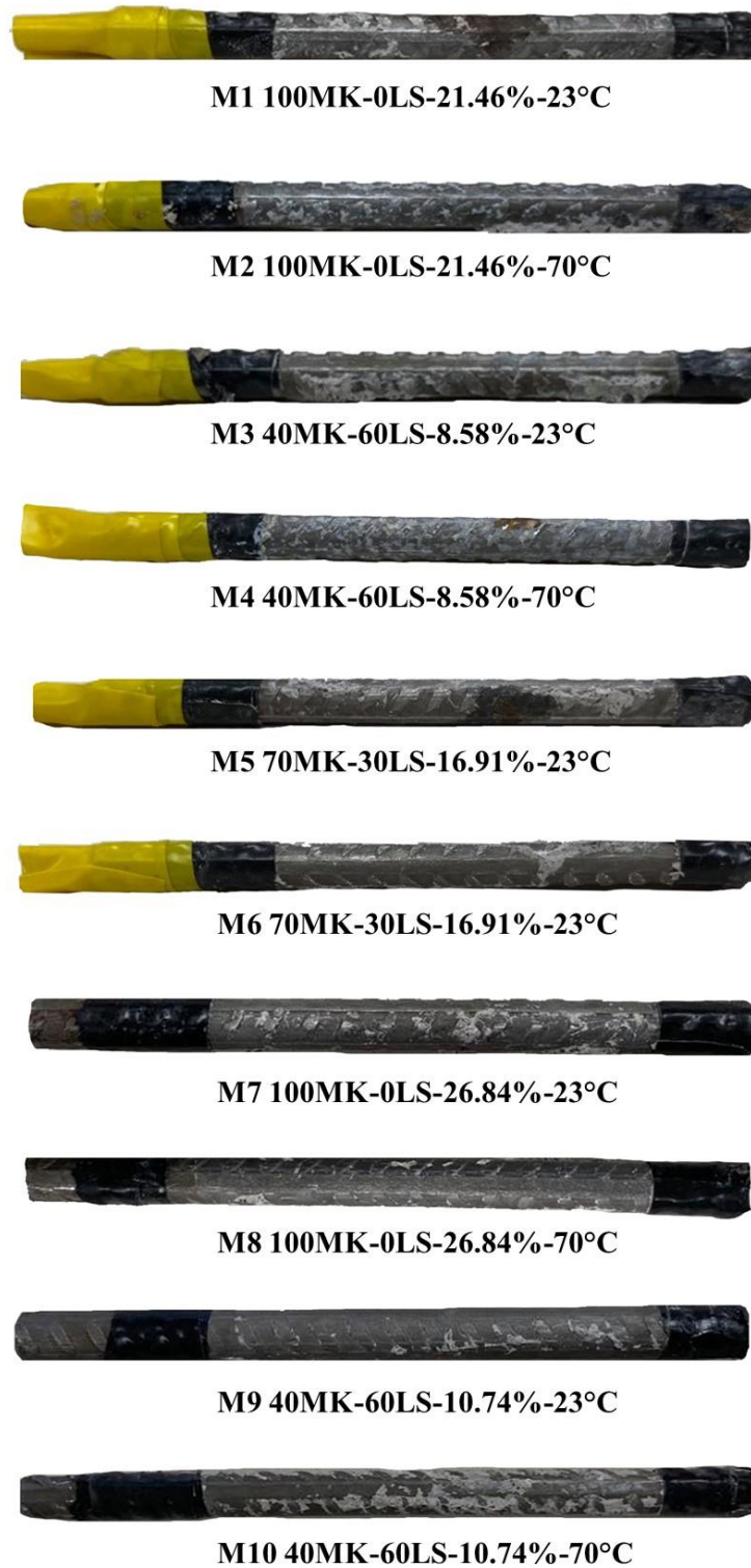
Figura 73. Imágenes de varillas embebidas en MAA-LSMK expuestas durante 180 días a 4% CO 2 .
