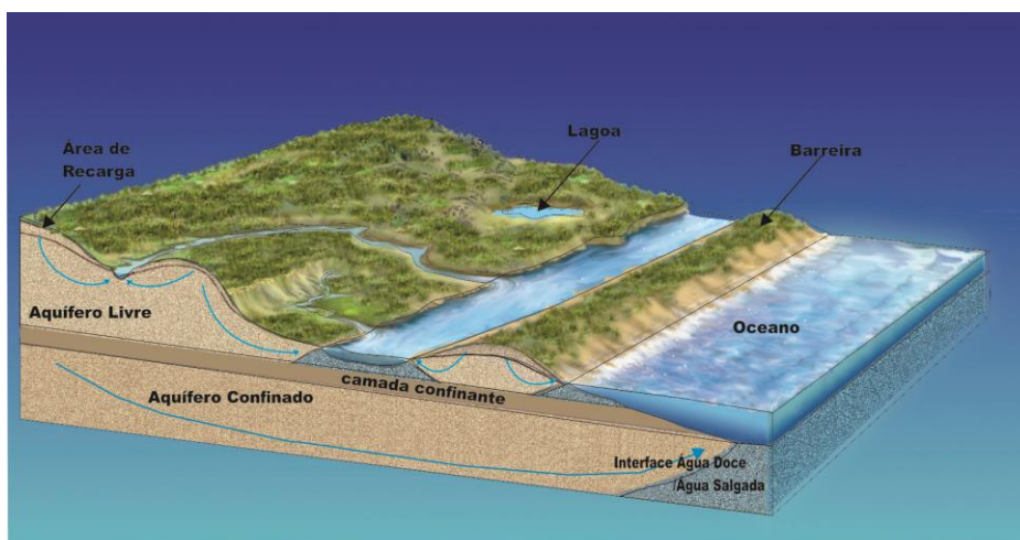
Figura 3: Modelo hidrogeológico conceitual de um sistema aquífero costeiro. Modificado de Barlow, 2003.
