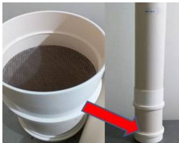
Figura 19. Coluna de lixiviação. Em detalhe malha de nylon e recipiente de coleta de lixiviado anexo à coluna de lixiviação
