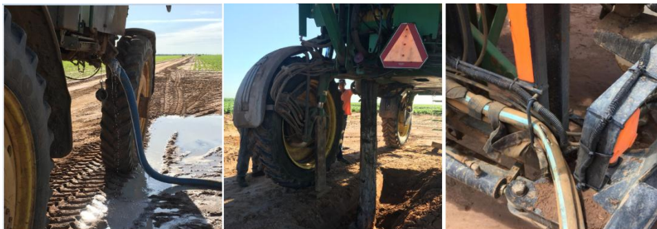
Figura 8. Danos e desgaste em mangueiras e troca de pneu na operação.
