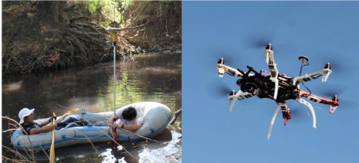
Figura 4. Vuelo de dron y georreferenciación de puntos de control con estación total para un estudio de hidrología.
