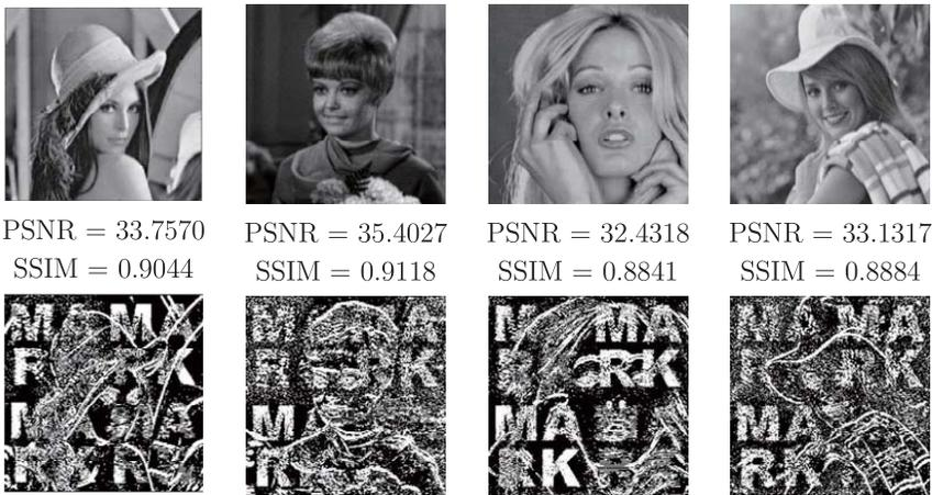
図 14: 電子透かし入り画像 (上段) とそれから抽出した透かし画像 (下段)
