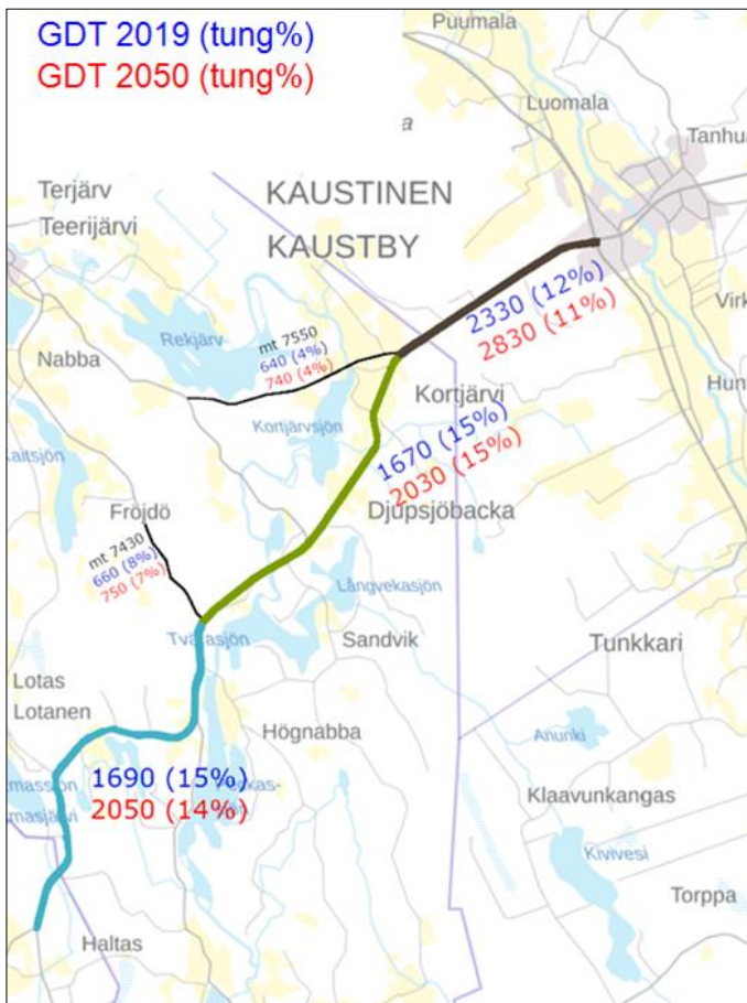
Bild 9. Trafikmängder i nuläget (2019) och enligt prognosen (2050) på landsvägarna i utredningsområdet (bakgrundskarta © LMV).
