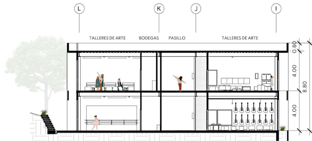
SECCIÓN TRANSVERSAL EDIFICIO NÚM. 1
