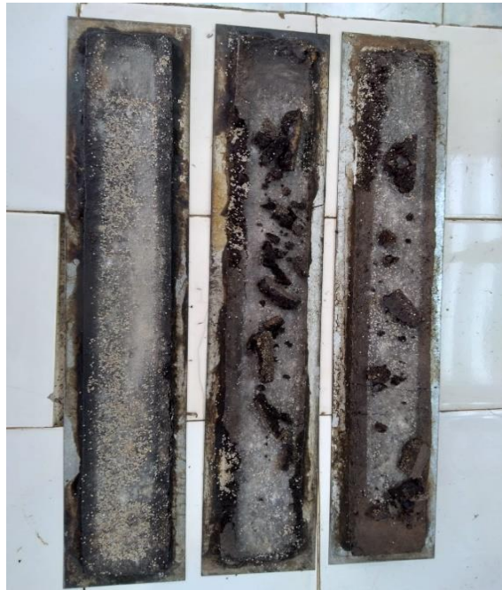
Figura 23. Especímenes con distintos porcentajes de emulsión después del ensayo de adherencia de arena con rueda cargada
