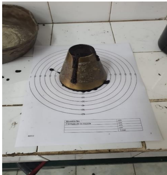
Figura 20. Evaluación de la consistencia de la mezcla mediante el cono de arena sobre la escala graduada, utilizando distintos porcentajes de agua
