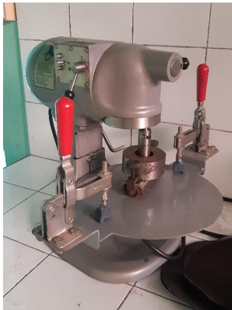
Figura 24. Maquina Hobart para ensayo de abrasión húmeda
