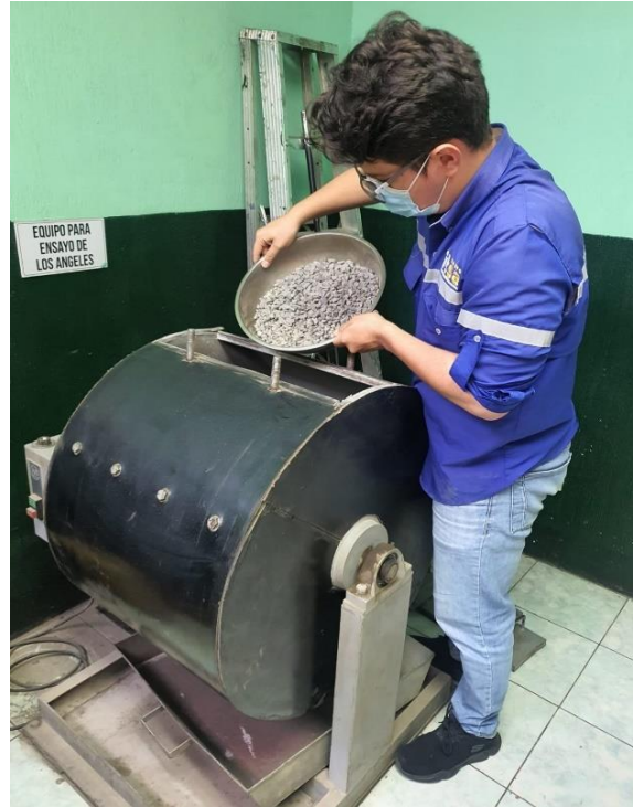
Figura 17. Proceso de realización del ensayo de desgaste por abrasión e impacto
