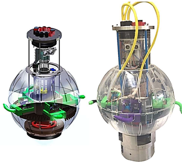
Figura 1.3: diseño CAD de Robotino 2.0 (izquierda) y su correspondiente implementación (derecha).
