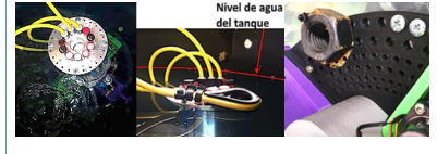
Fig. 5: (izquierda) prueba de estanqueidad, (centro) prueba de flotabilidad y (derecha) prueba de estabilidad.
