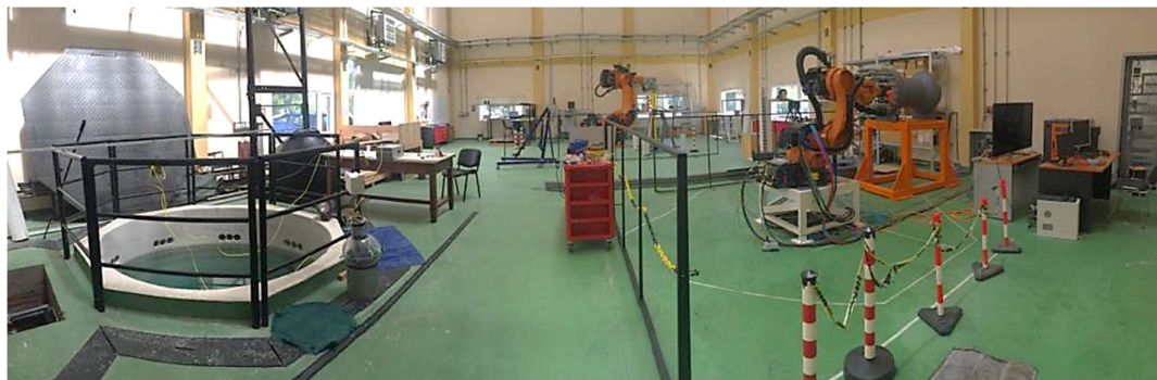
Figura 1.6: laboratorio de robótica del proyecto CAREM. A la izquierda, el pozo de agua de las dimensiones del recipiente de presión del reactor.
