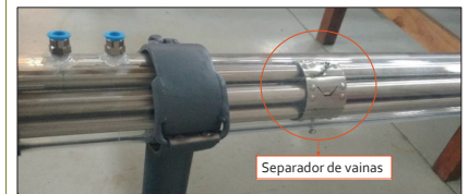
Ensayo con siete vainas sostenidas por separadores
