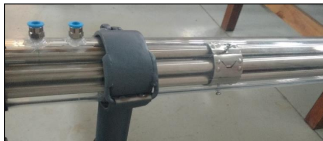
Figura 5 – Sección de ensayos con siete vainas, similar a elemento combustible nuclear (ECN)
