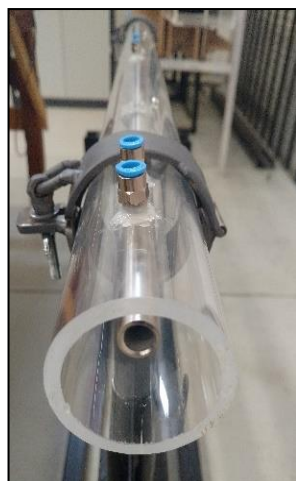
Figura 4 – Sección de ensayos con vaina paralela al flujo
