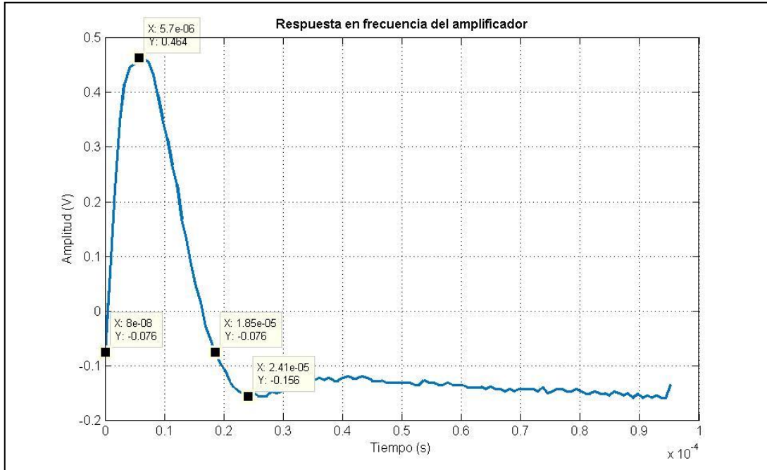
Figura 10 – Respuesta a una entrada tipo escalón del sensor de hilo caliente y su electrónica asociada
