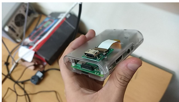
Figura 2.1: Raspberry 3B+ utilizada con su respectivo adaptador HDMI para la conexión con la cámara.
