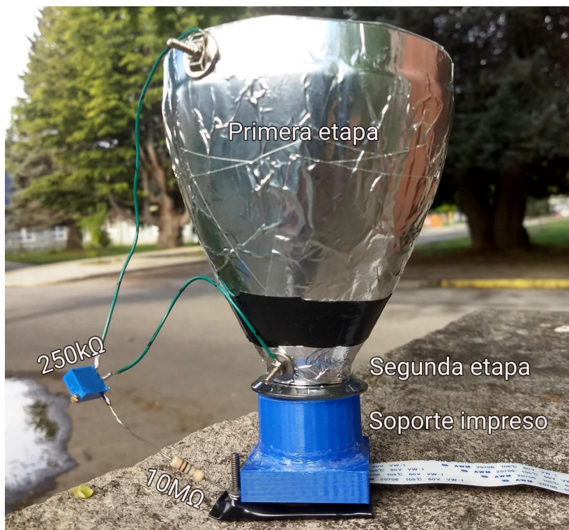
Figura 3.2: Dispositivo experimental implementado y utilizado para la medición de ^{222}\text{Rn} .
