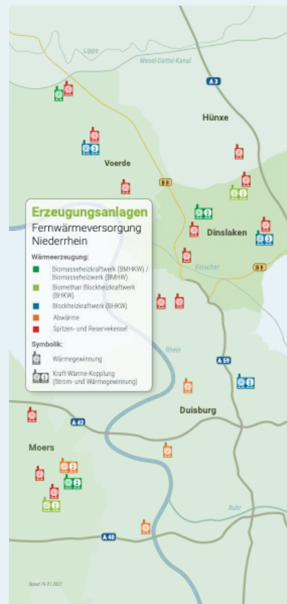
Abbildung: Erzeugungsanlagen der Fernwärmeversorgung Niederrhein; Quelle: Freundliche Bereitstellung durch die Stadtwerke Dinslaken 2021
