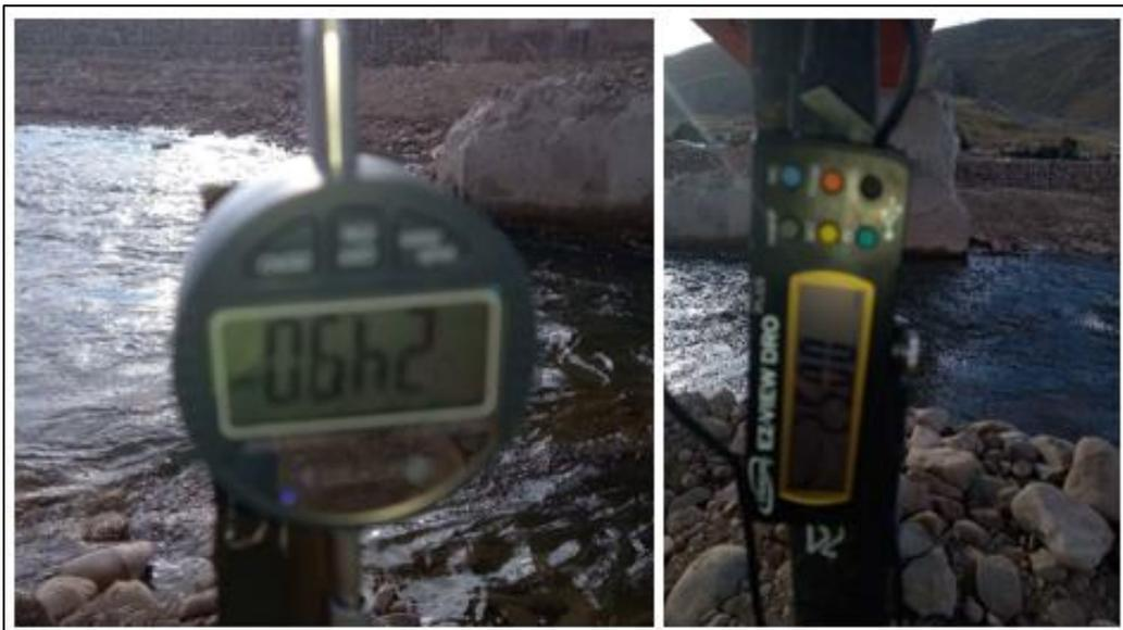
*Comentario: Durante el proceso de carga y descarga de los volquetes, se deben registrar en la ficha de campo las deformaciones producidas durante la prueba de carga.*
