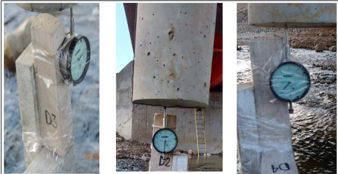
*Comentario: Durante el proceso de carga y descarga de los volquetes, se deben registrar en la ficha de campo las deformaciones producidas durante la prueba de carga.*
