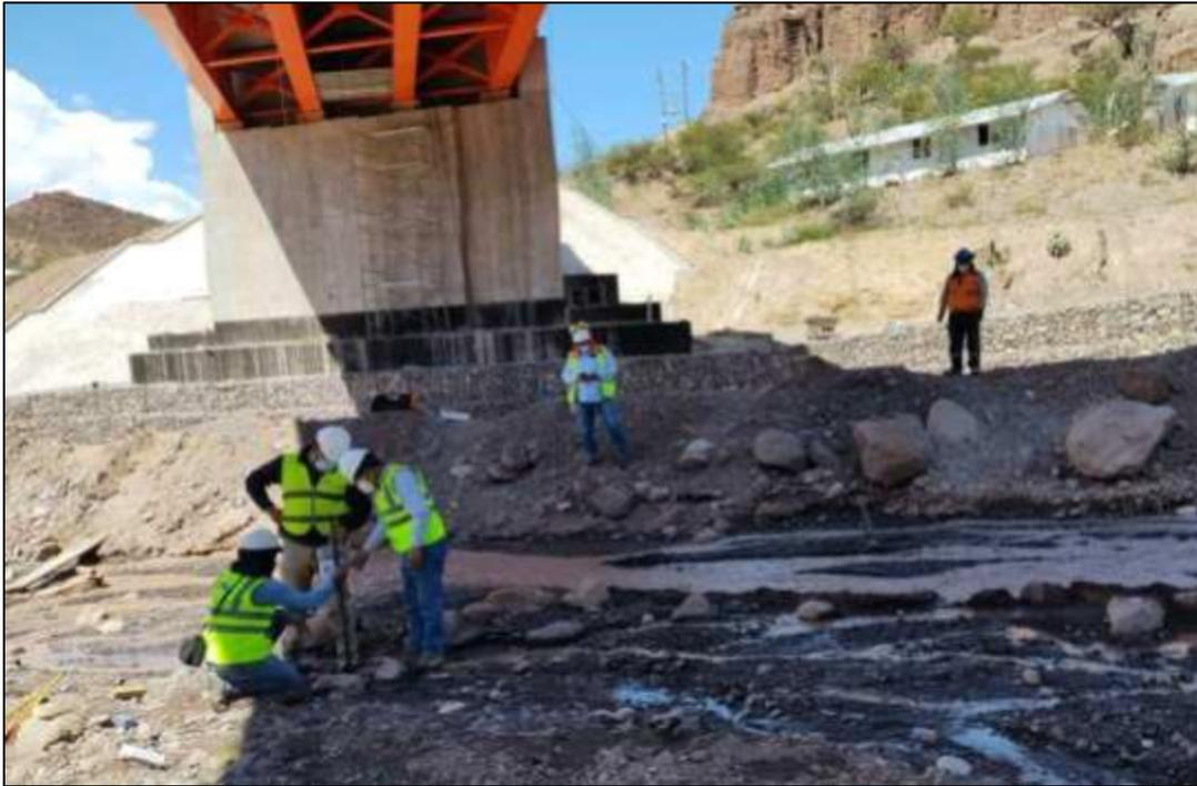
*Comentario: Para la toma de datos de los deformímetros se colocaron a  $1/4 L$ ,  $1/2 L$  y  $3/4 L$ , en la imagen se puede apreciar que el equipo técnico está instalando los deformímetros antes del inicio de la prueba de carga.*
