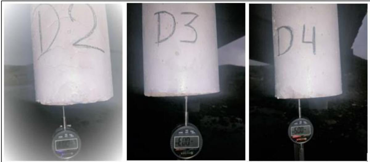
*Comentario: Durante el proceso de carga y descarga de los volquetes, se deben registrar en la ficha de campo las deformaciones producidas durante la prueba de carga.*
