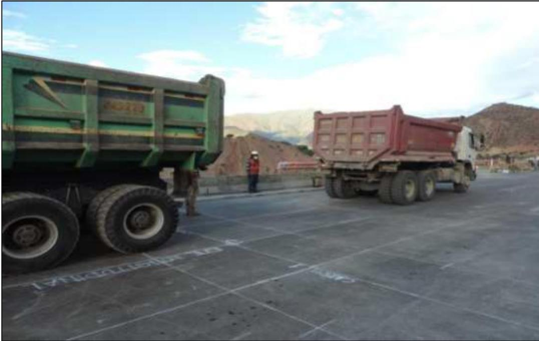
*Comentario: Se realizo un trazado de los ejes en el tablero del puente, antes de la colocación de cargas para la prueba de carga, para este puente se trazaron los ejes de 04 volquetes.*
