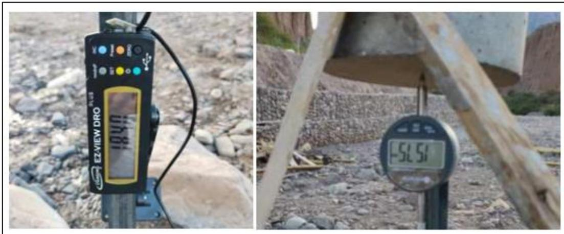
*Comentario: Durante el proceso de carga y descarga de los volquetes, se deben registrar en la ficha de campo las deformaciones producidas durante la prueba de carga.*
