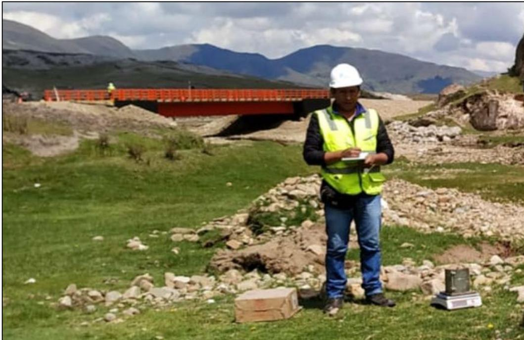
*Comentario: Debido a que en el entorno de puente no había balanzas para pesar los volquetes, se procedió a cargar con material de relleno los volquetes y se determinó su peso unitario.*
