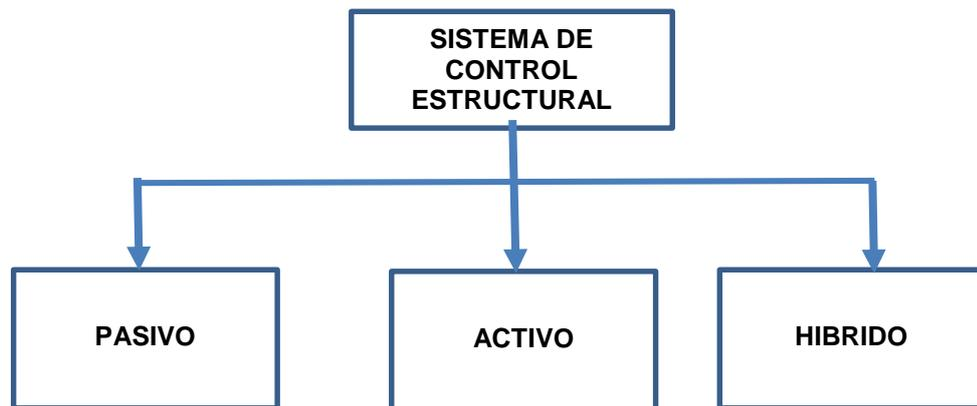
**Figura 2.-Clasificación de los sistemas de control estructural**
