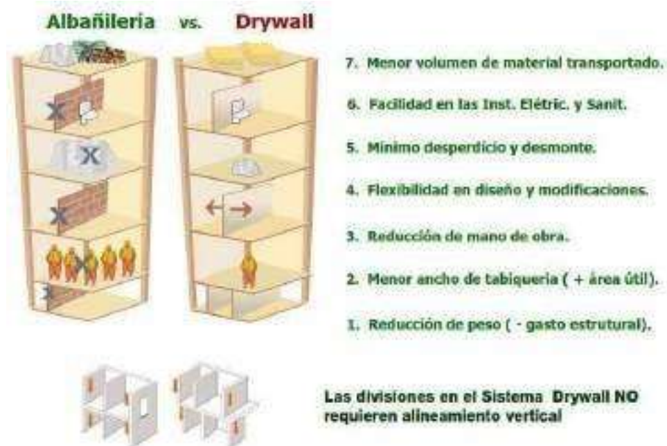
Figura 5 Ventajas del sistema Drywall sobre al sistema tradicional (Albañilería).
