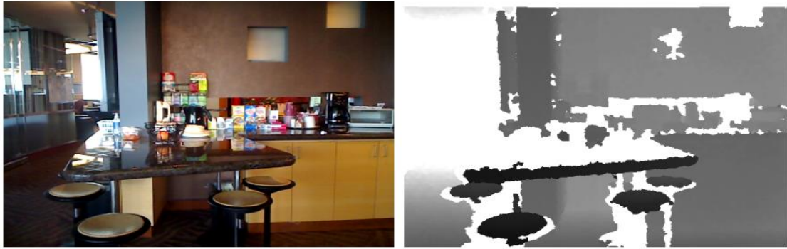
Figura 2.3 Imagen RGB (Izquierda) e imagen de profundidad (Derecha) capturados por una cámara RGB-D. Fuente: [21]
