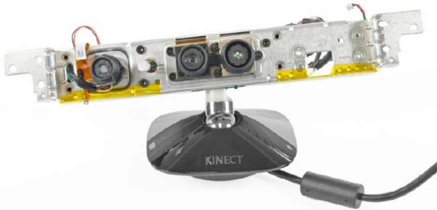
Figura 2.5 La Kinect por dentro. De izquierda a derecha: Proyector IR, cámara RGB y cámara IR.
