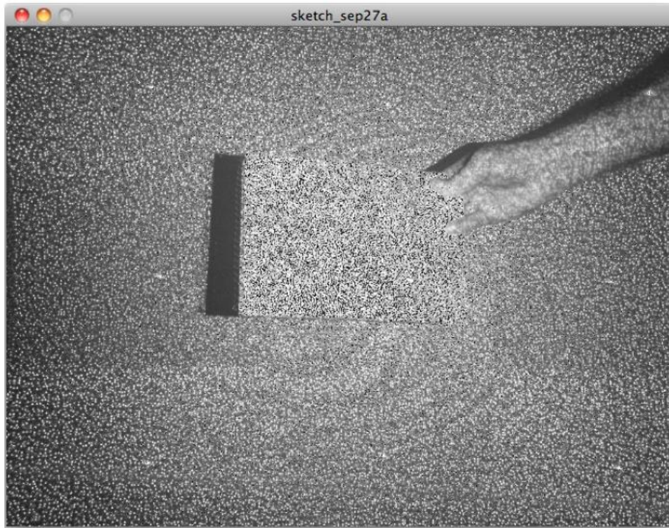
Figura 2.6 Imagen de puntos IR proyectados sobre una superficie y un cuaderno. Fuente: [28]
