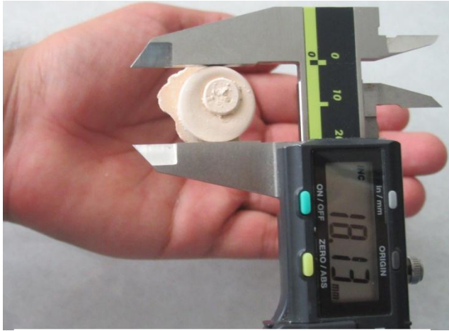
Fotografía 26. Medición del diámetro de uno de los modelos de los grupos experimentales.
