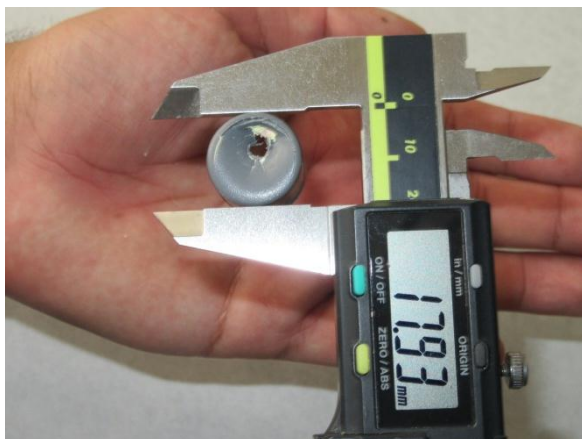
Fotografía 24. Medición del diámetro de uno de los modelos maestros.
