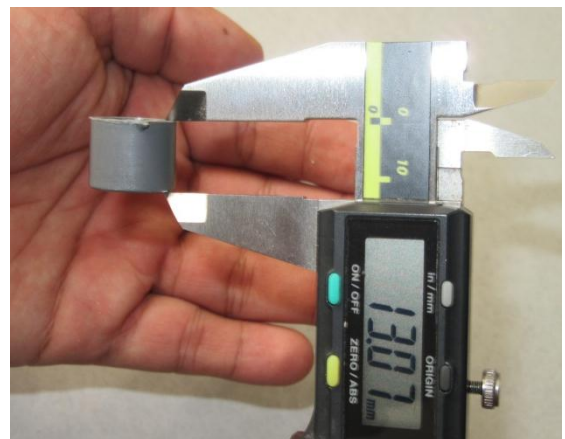
Fotografía 25. Medición de la altura de uno de los modelos maestros.
