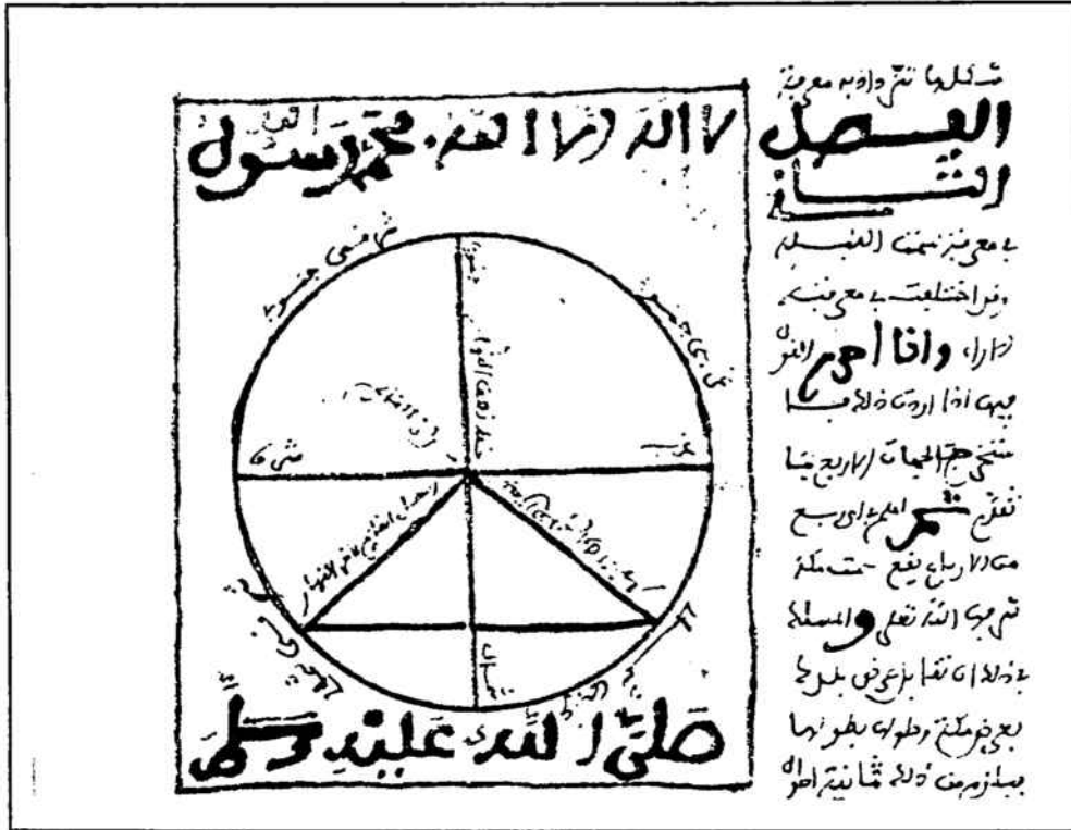
Figura 31.- Obtención de los puntos cardinales con el círculo indio.
