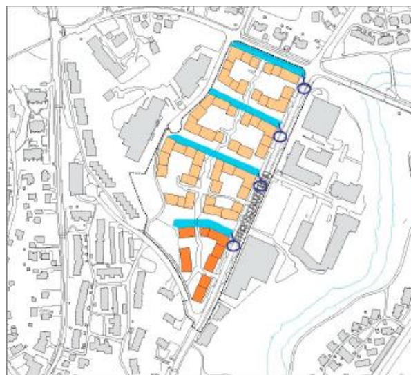
Figur 17: Prinsippløsning for overvannshåndteringen (Kilde: Oslo kommune, Saksnummer: 201711346, 10.10.17)
