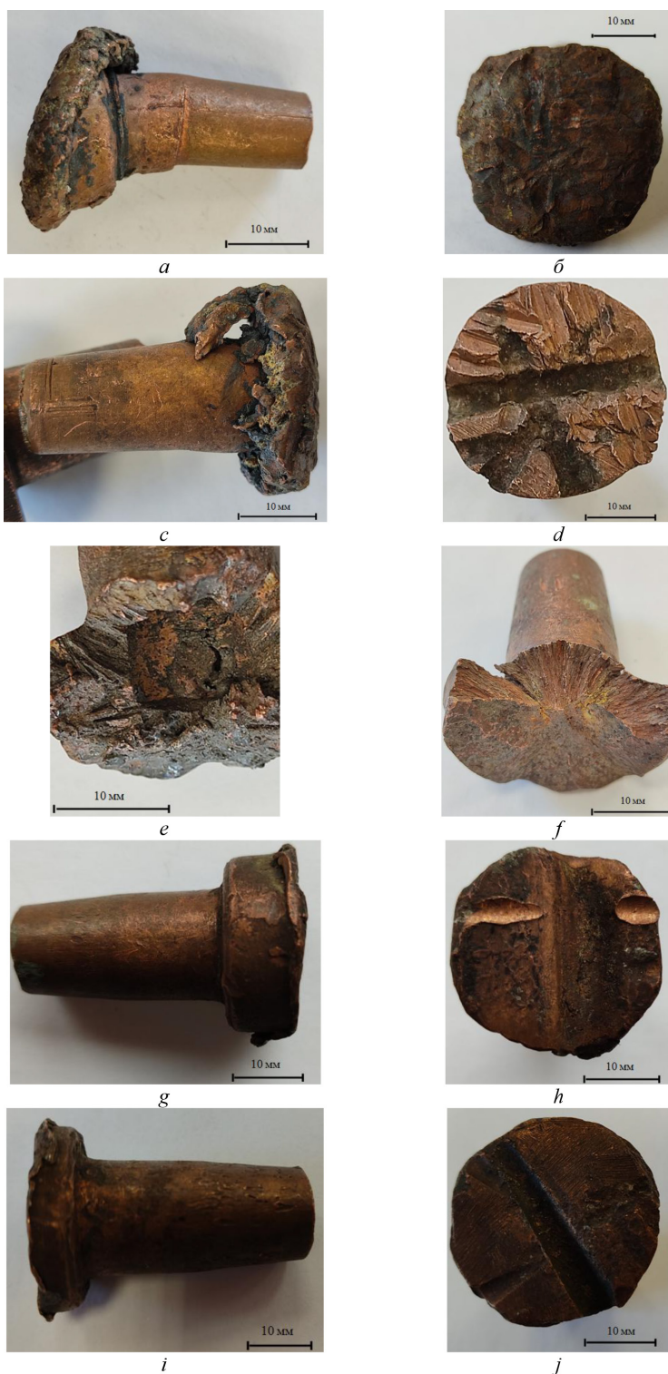
Рис. 13. Образцы изношенных и разрушенных в процессе эксплуатации электродов: a, b – образцы электродов 1; c, d – образцы электродов 2; e, f – образцы электродов 3; g, h – образцы электродов 4; i, j – образцы электродов 5
