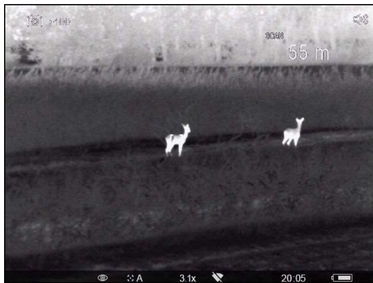
3. ábra: Hőkamerával észlelt és SCAN üzemmódban megmért távolságban lévő őzek Figure 3: Roe deer with distance indication, detected by a thermal camera and measured in SCAN mode
