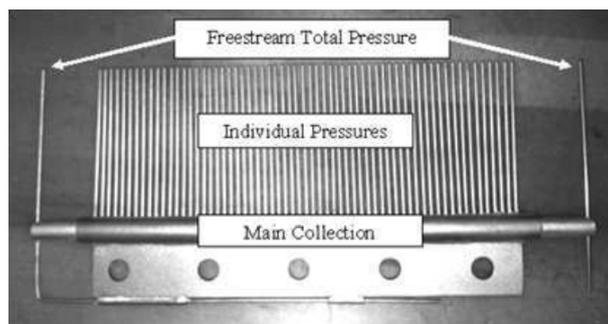
Abb. 3.10: Integrierender Rechen aus [15]
