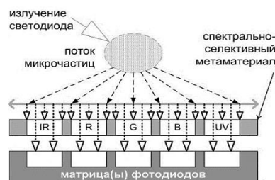
Рисунок 1 – Схематическое изображение принципа работы мультиспектрального детектора микрочастиц с использованием оптических фильтров на основе метаматериалов на плазмонных эффектах в сборке с матрицей фотодиодов
