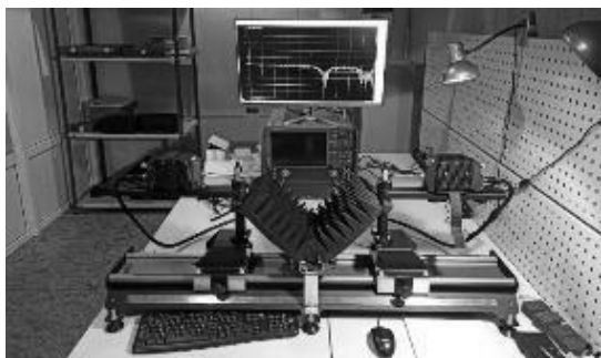
Рисунок 2 – Аппаратно-программный комплекс для измерения параметров материалов на базе векторного анализатора цепей N5290A фирмы Keysight Technologies (США)
