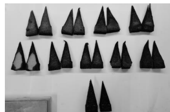
Рисунок 1 – Пирамидальные РПМ в разрезе, изготовленные различными методами
