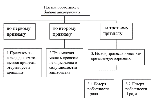
Рисунок 1 – Классификация ситуаций потерь робастности производственных процессов как их неприемлемости в соответствии с классификацией признаков некорректности задач
