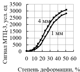
Рисунок 2 – Зависимость сигнала прибора МТЦ-3 от степени деформации при толщинах образцов 1 и 4 мм
