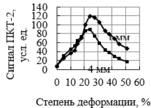
Рисунок 4 – Зависимость сигнала прибора ПКТ-2 от степени деформации при толщинах образцов 1 и 4 мм
