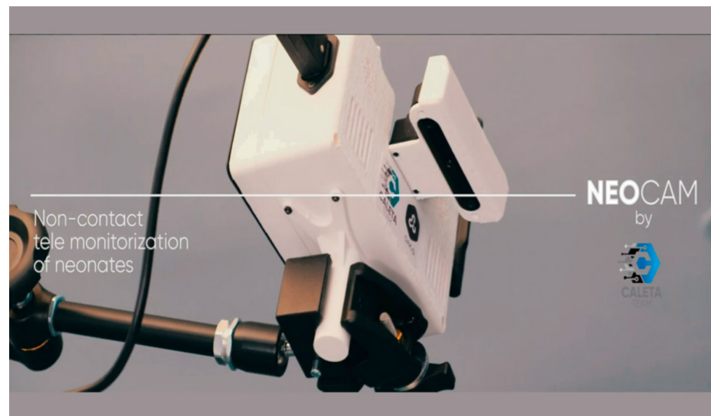
Figura 1. NeoCam, sistema de telemonitorización de neonatos sin contacto.
