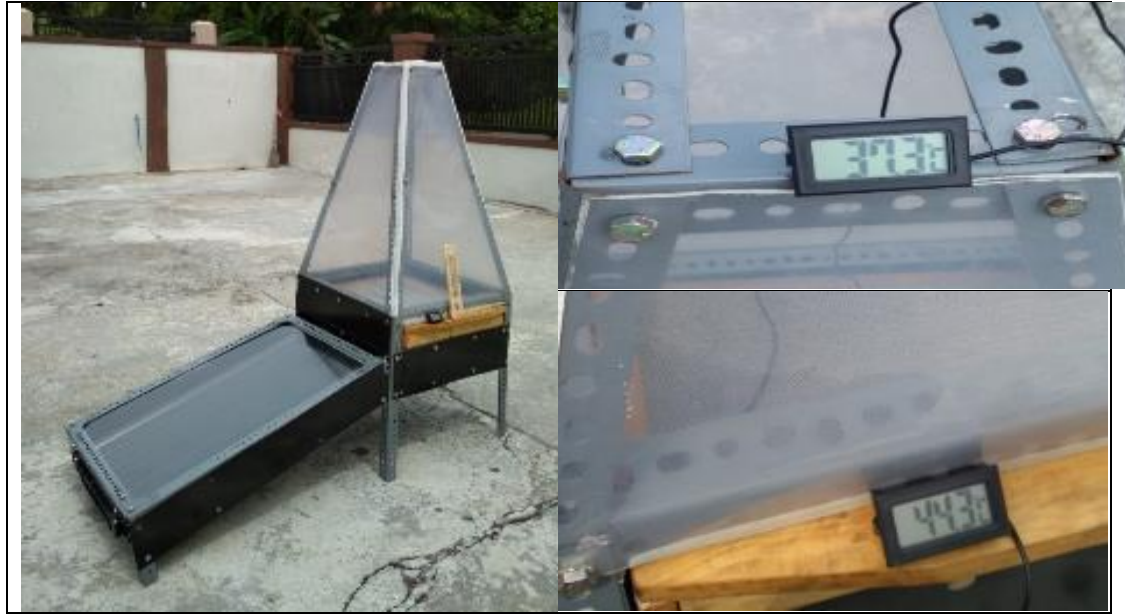
Gambar 8. Prototype alat pengering kolektor surya, dimana suhu normal 37.3 0 C dan suhu pemanas dalam 10 menit pemaparan sinar matahari mencapai 44.3 0 C
