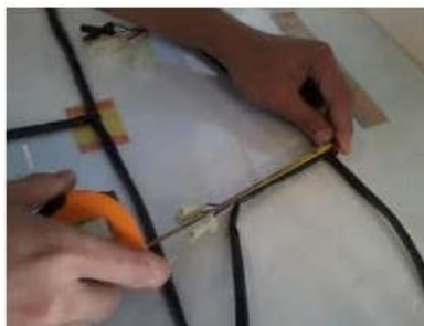
Gambar 19. Proses Insulock di CV. HIJ
