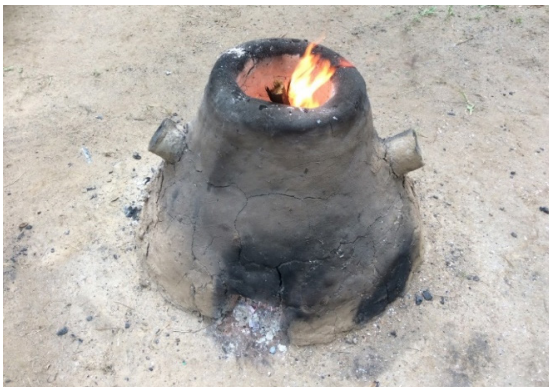
Gambar 2. Bloomery furnace eksperimen pada Festival Kedah Tua Malaysia 2016 (Sumber: Sofian 2016)
