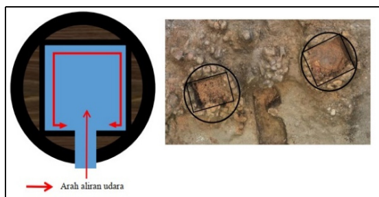
Gambar 8. Ilustrasi pola aliran udara yang dihembuskan dalam tungku yang berbentuk bulat di Buren Temelalo (Sumber: Hartatik et al. 2018)
