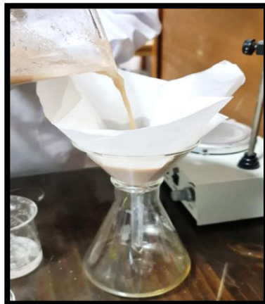
Filtración y lavado con agua destilada
